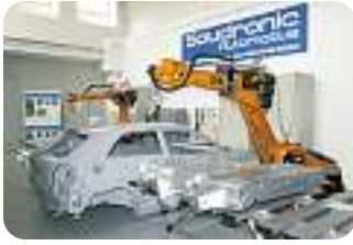
a: Die Laserlötnaht im AUDI A3. | b: Soudronic-Applikationslabor: Auch im Serieneinsatz wird Souvis 5000 von einem Roboter geführt.
