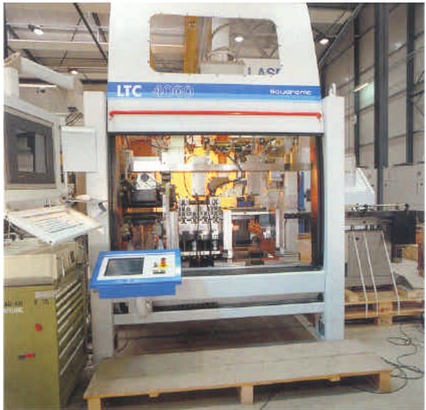
In der Schweißstation der Pilot-Fertigungsanlage entstehen auch Prototypen unter Serienbedingungen.
