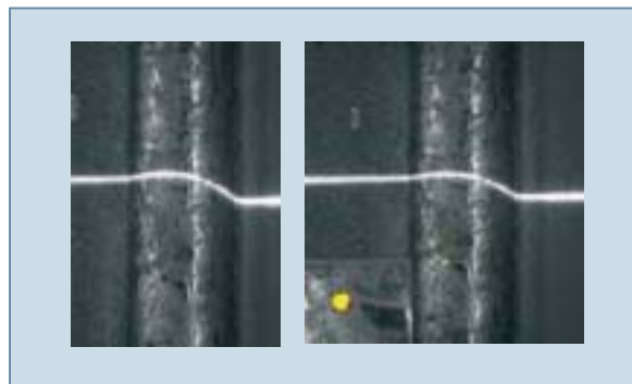
Bild 2. Mit Porenanalyse geprüfte lasergelötete Naht. Die festgestellten Poren haben einen Durchmesser von nur 100 µm
