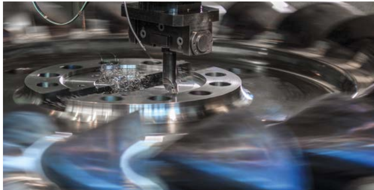
Maquinado de un rodete Pelton
