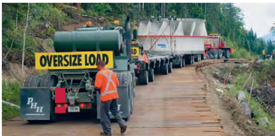
□ Entrega de rodete de 520 MW para la unidad #5 de la CH Mica en Colombia Británica
