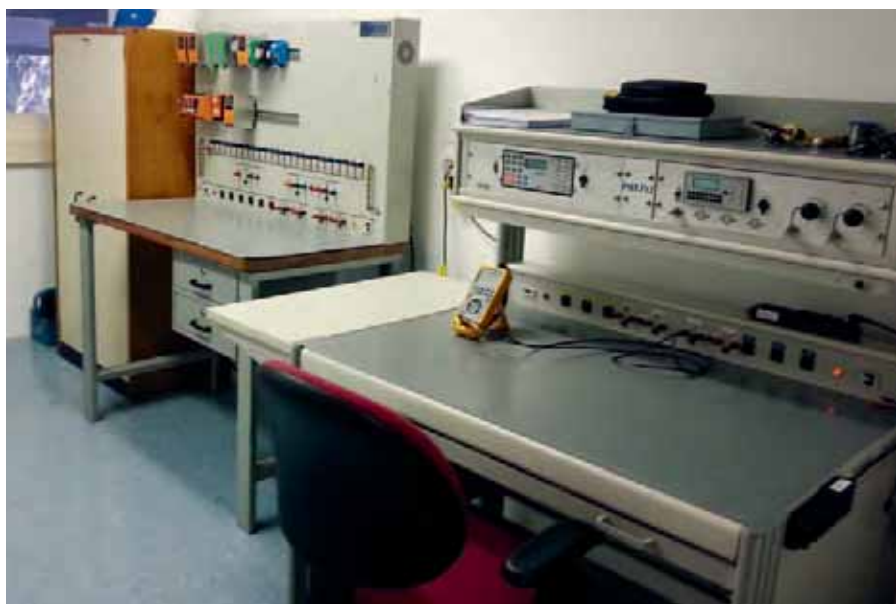
▫ Bancos de pruebas para instrumentación, PLCs, y redes de comunicación
