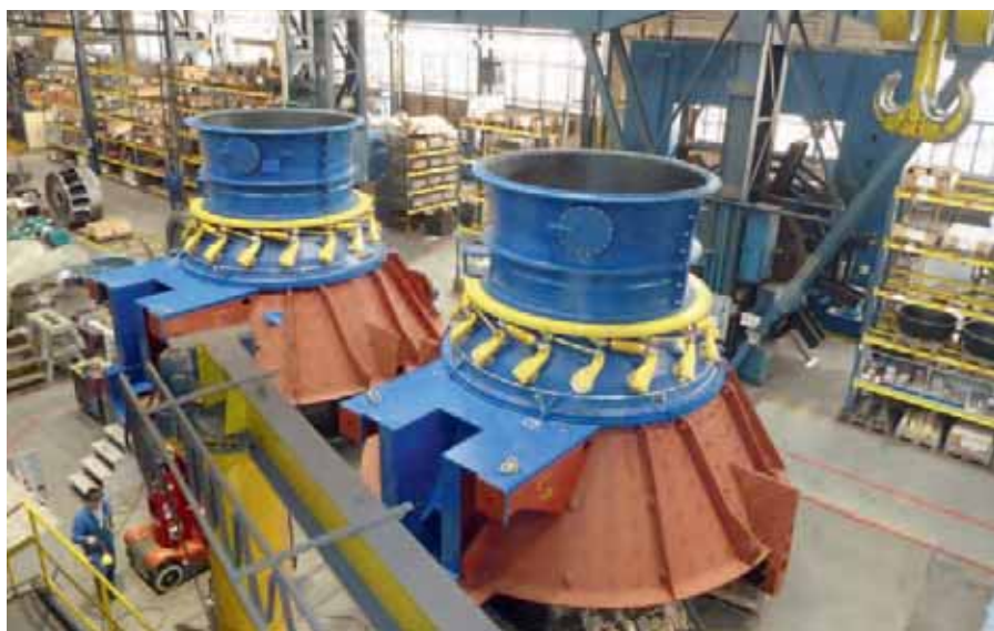
Turbina Compact Axial tipo Bulbo para CH Lixhe, durante ensamblaje en taller
