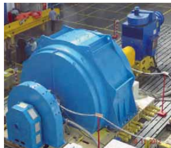
▣ Generador para CH Forrest Kerr en el banco de pruebas de ANDRITZ HYDRO India
