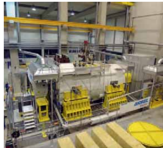
▣ Turbogenerador refrigerado por hidrógeno en el banco de pruebas
