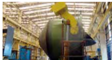
Válvula mariposa ensamblada en los talleres de ANDRITZ HYDRO en México
