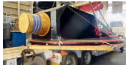
Preparación para el transporte del rotor de la válvula de 80 ton
