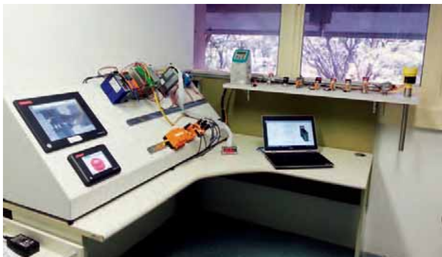
▫ Banco de pruebas móvil para el entrenamiento en redes ASi y banco de pruebas de instrumentos para el apoyo de actividades en sitio
